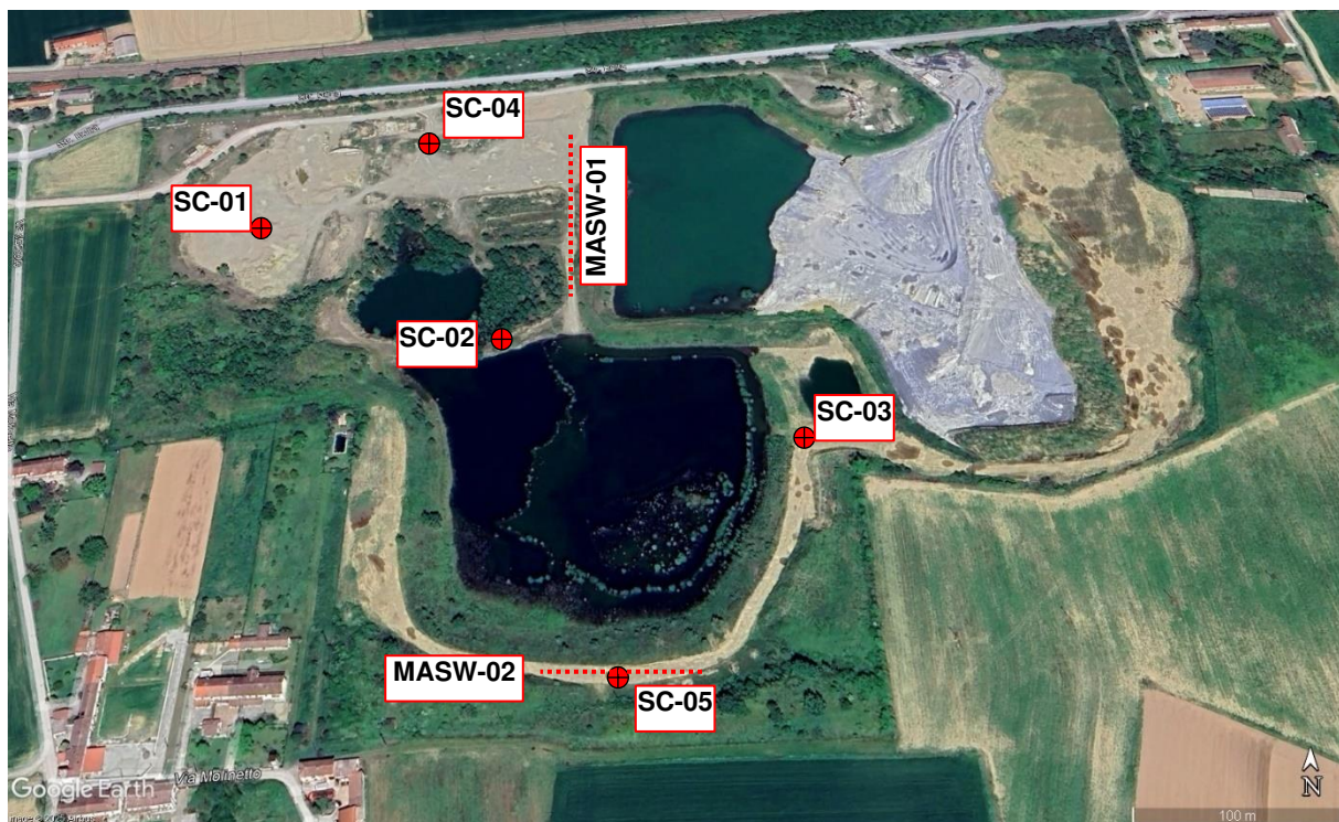
Figura 19 - Ubicazione su ripresa aerea delle indagini eseguite nella Campagna 2025: SC-01 ÷ SC05 sondaggi verticali a carotaggio; MASW-01 ÷ MASW-02 rilievi sismici MASW.
